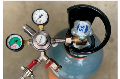
2. Ouvrir le robinet du tuyau (languette parallèle au tuyau)
